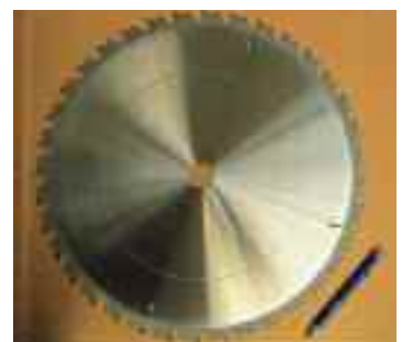
Universelles Kreissägeblatt für das Zimmerhandwerk
